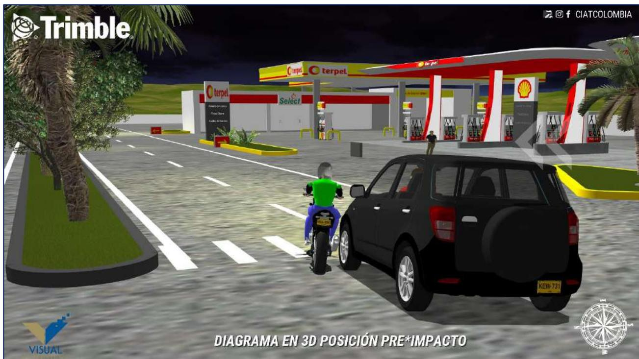
**IMAGEN 3.** Imagen en 3D, tomada del software de reconstrucción Edge FX. A partir de la nube de puntos obtenida durante la investigación de campo, demuestra la posición pre-impacto de los participantes.
