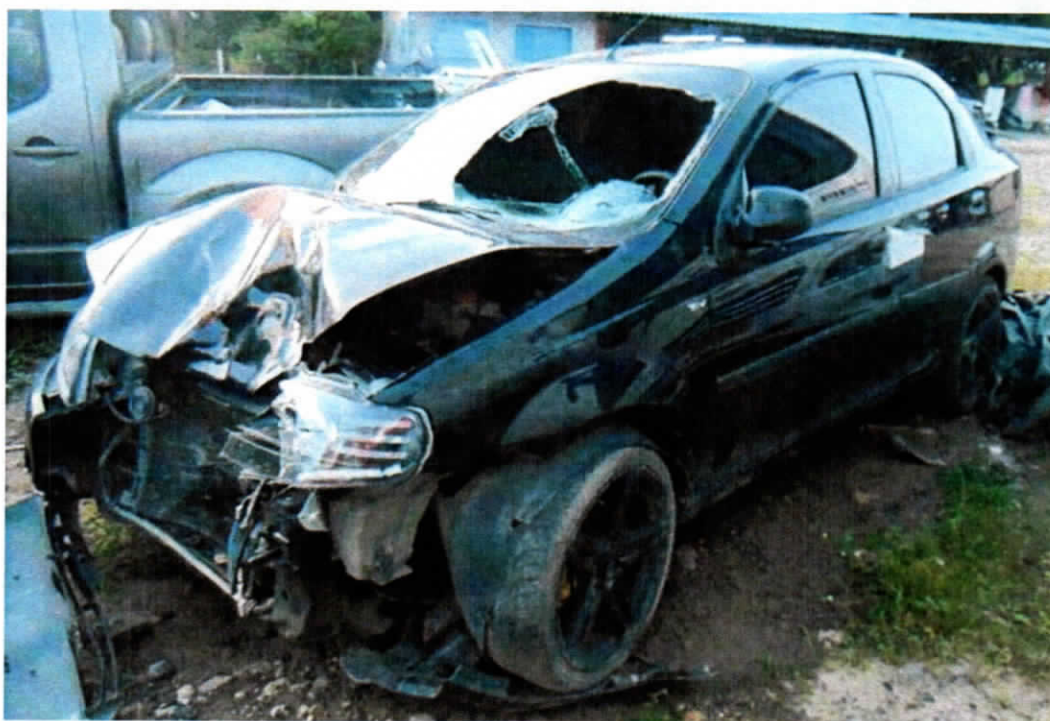
FOTOGRAFÍAS No. 3 Y 4: En estas fotografías se aprecia el estado final de la zona frontal y lateral derecha e izquierda del automóvil.
