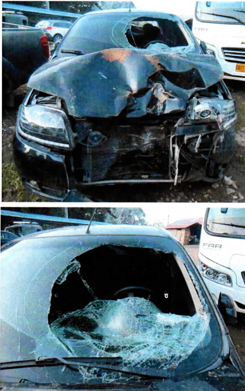
FOTOGRAFÍAS No. 7 Y 8: En estas fotografías se aprecian los daños en la zona frontal del automóvil.
