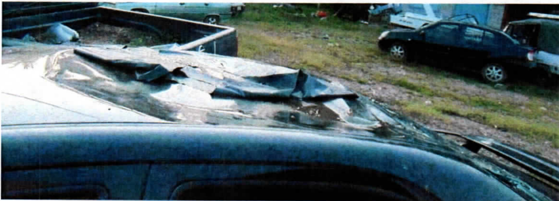
FOTOGRAFÍAS No. 9, 10, 11: En estas fotografías se aprecian las deformaciones en la zona superior del automóvil.
