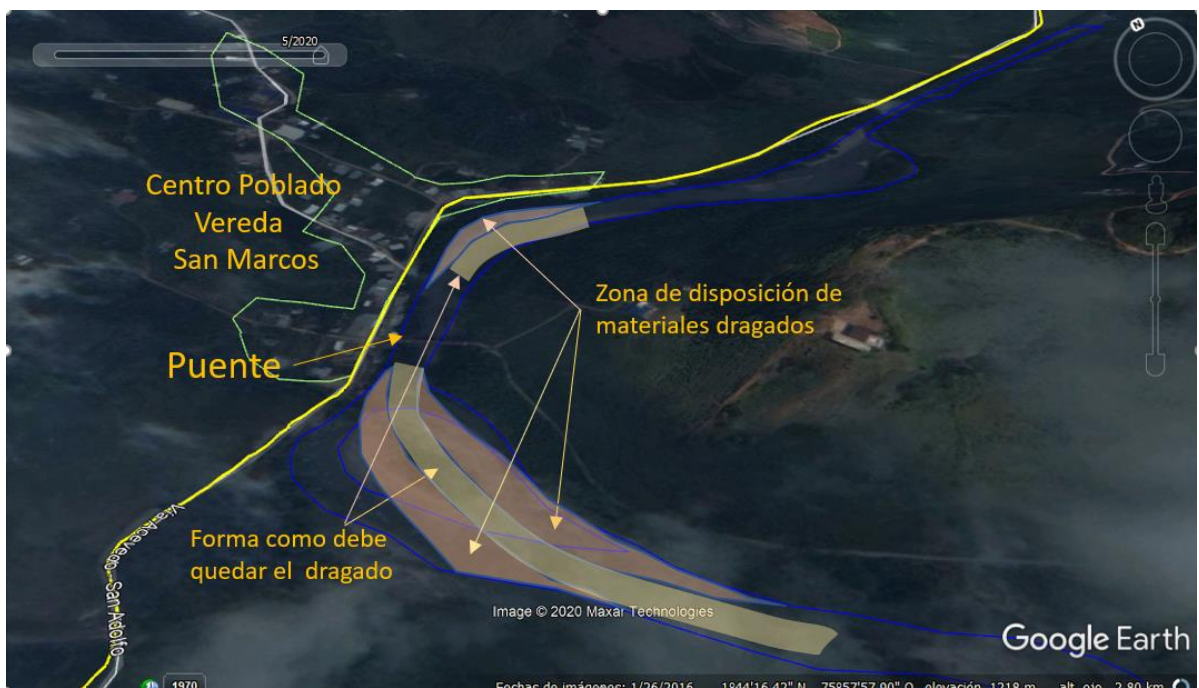
Imagen 7. Detalles como debería quedar las zonas de dragado del río Suaza en los sectores de la vereda San Marcos.
