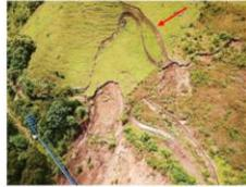
Fig.2. Vista de la zanja en la corona del deslizamiento.
