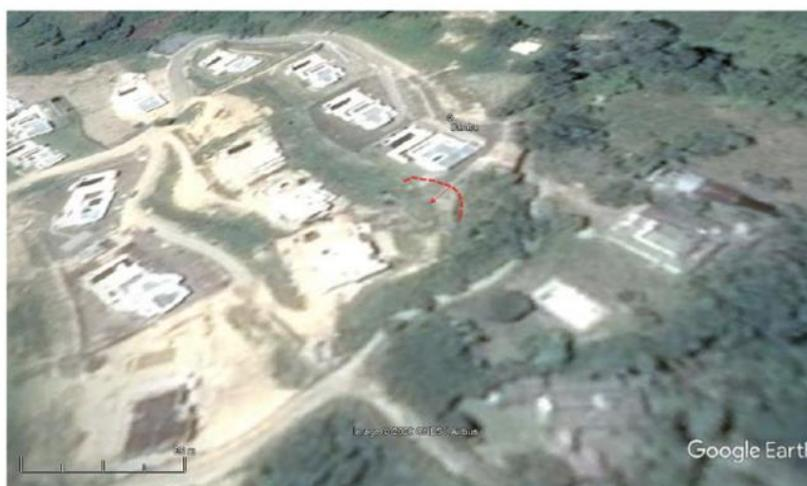
Figura 10. Análisis imagen de finales 2015. Persiste la presencia de la corona del antiguo movimiento en masa. Se observa el avance de la construcción del muro en suelo reforzado en el límite entre ambos predios de estudio
