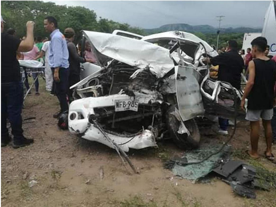
**FOTOGRAFÍA No. 5 PLANO MEDIO:** En esta fotografía se aprecia el estado final del vehículo, el cual presenta daños en su zona anterior, afectando piezas como: paragolpes anterior, unidades de luz, capó, persiana, guardafangos anteriores, ejes anteriores, paraleles anteriores, puertas anteriores, panorámico anterior y capota y daños internos por establecer.
