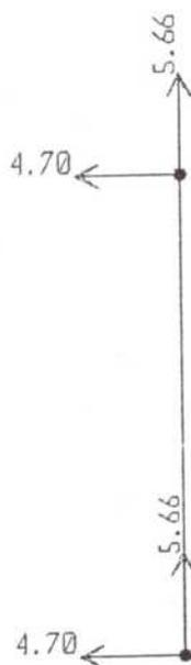
Figura 16 Reacciones para la combinación 1.2D + W
