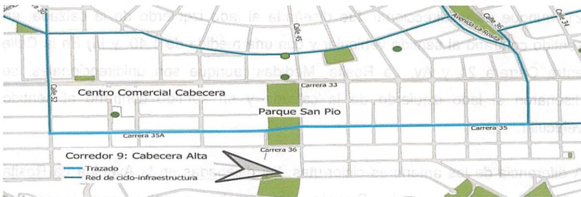
Carrera 35 entre Calles 36 y 45: En este tramo será una ciclorruta unidireccional en sentido contrario del tráfico mixto al costado oriental y un carril ciclopreferente con tráfico compartido en el sentido del flujo al costado occidental, reduciendo el número de carriles mixtos de dos a uno.
