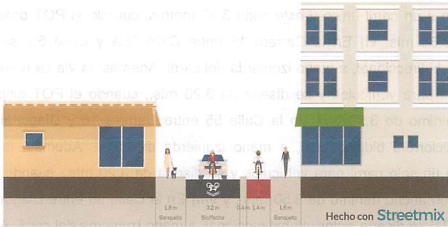
Carrera 11 entre calles 34 y 35: Para este tramo se hará una ciclorruta unidireccional en el costado oriental de la vía en contrario del sentido del carril mixto, donde se implementa un carril ciclopreferente
