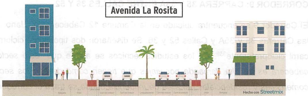
Avenida “La Rosita” correspondiente a tramo 5, entre siete bocas y glorieta Chicamocha, con diseños de ciclorrutas unidireccionales externas adyacentes al andén conforme sentido vial, se reduce el perfil vial de tres carriles vehiculares a dos.<sup>358</sup>
