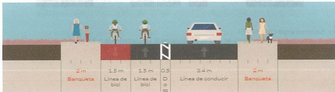
\* Calle 55 entre carreras 3W y 2W. Ciclobanda bidireccional de 3 metros de ancho (1.5 metros cada carril), con separación de 0.5 metros y ancho de calzada de 3.4 metros.
