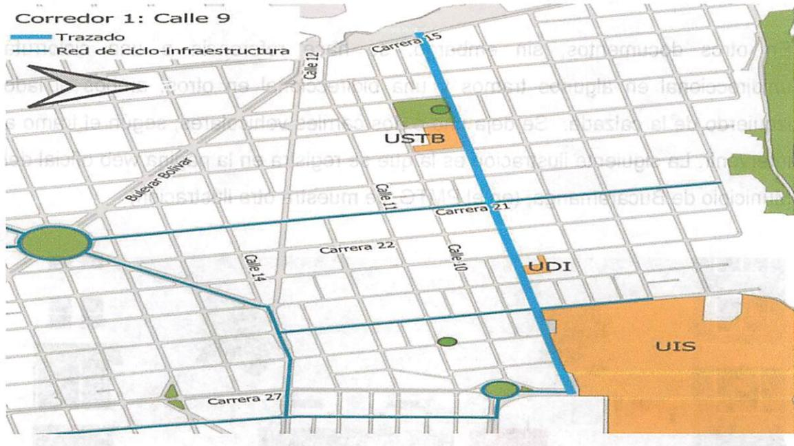
Este corredor de ciclorruta si bien se encuentra ubicado en una vía local del nivel 1 (habilitada por el POT según art. 106, literal a) y respeta el ancho mínimo del carril y la ciclorruta (1.60 mts y 3.50 mts), **viola las especificaciones mínimas del POTB**, en cuando a ubicación y sentido, porque se diseña sobre el lado izquierdo de la calzada y con flujo en contra del sentido vehicular.
