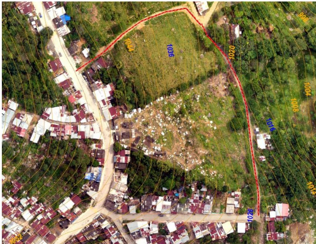
Ilustración 1. levantamiento topográfico con fotogrametría
