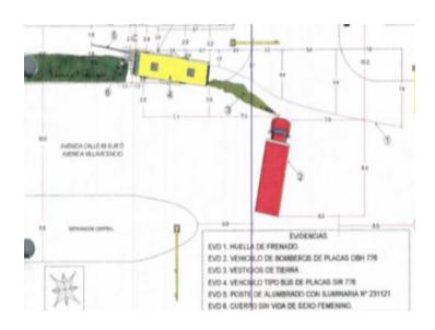
Así las cosas, los impactos sufridos por cada uno de los vehículos y la disposición final de éstos luego del choque, permiten concluir que la máquina de bomberos impactó por un costado a la buseta de servicio público y ésta desvió su desplazamiento hacia la acera hasta que se encontró con un poste de alumbrado público y arrolló a los peatones, entre los que se encontraban los demandantes.
