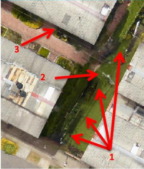
1. Parches oscuros, sin continuidad geométrica (posición xy) y radiométrica (color) producto de la mala edición de líneas de costura (seemlines)
