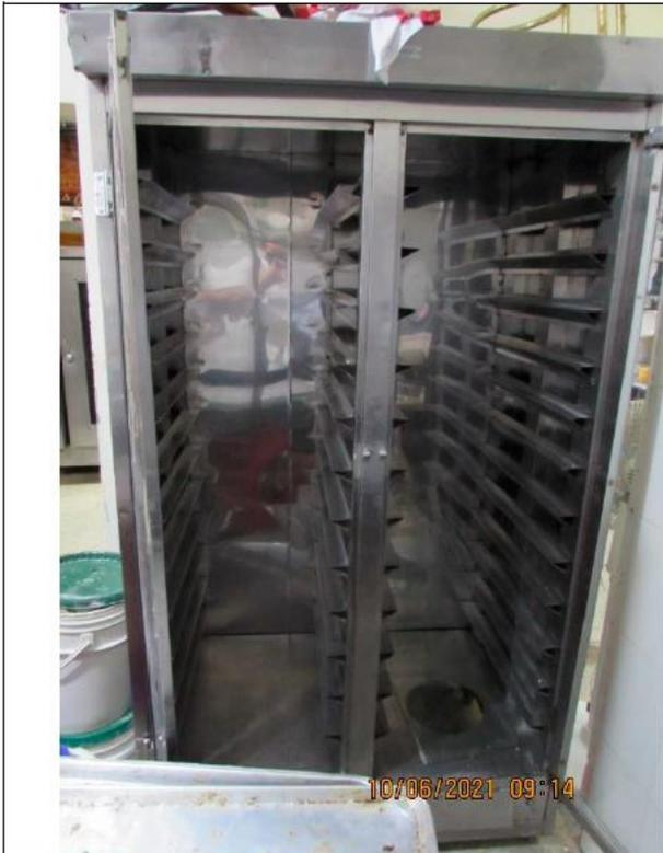
Una vitrina o cuarto de crecimiento de pan con dos compartimientos para 26 bandejas, cuenta con hornilla, puertas en vidrio, estructura en acero inoxidable, marca vitrinas la Especial. Este equipo no se encuentra en funcionamiento. Requiere mantenimiento correctivo.
