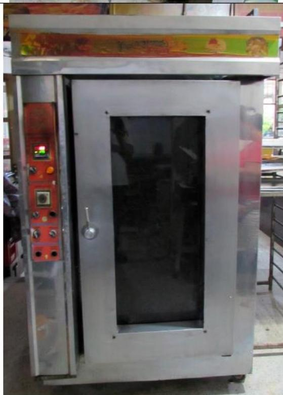
Horno turbo rotatorio, funciona a gas y con electricidad, se encuentra funcionando y en regular estado de conservación, requiere mantenimiento preventivo.
