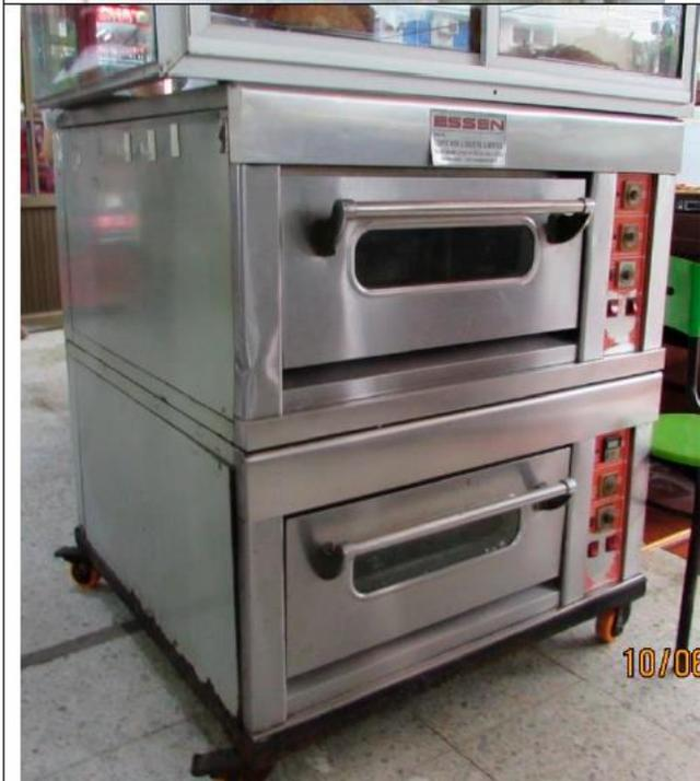
Horno industrial a gas marca Essen, con dos cámaras. No se encuentra en funcionamiento debido a que esta averiado. Requiere mantenimiento correctivo.
