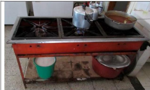
Estufa industria a gas con tres puestos, color zapote, no se pudo precisar marca ni referencia alguna ya que carece de esta información, no presenta las válvulas o perillas de encendido que son utilizadas para controlar la cantidad de llama y el paso del gas, los quemadores no funcionan correctamente. Se encuentra en regular y requiere mantenimiento correctivo.
