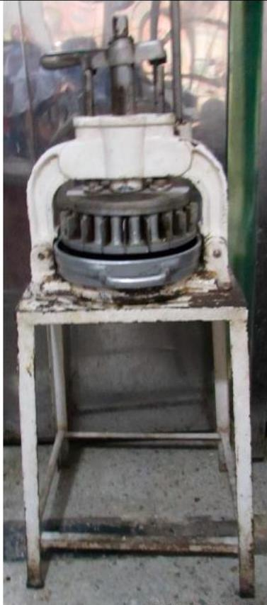
Maquina cortadora de pan, estructura metálica y aluminio con cuchillas en acero inoxidable, se encuentra en funcionamiento, en regular estado de conservación.
