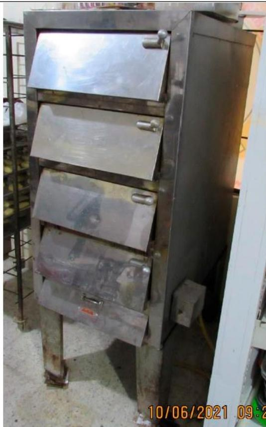
Horno a gas con cinco compartimentos, estructura en acero inoxidable, marca Superior. Requiere mantenimiento preventivo, se encuentra en regular estado de conservación.
