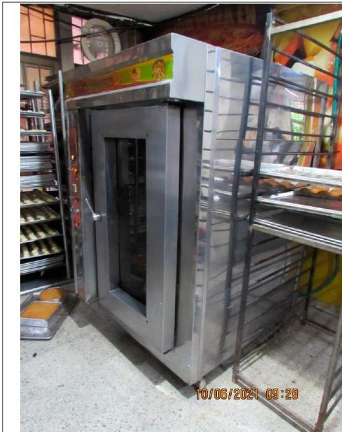
IMG36 Horno turbo rotatorio 3 compartimentos
