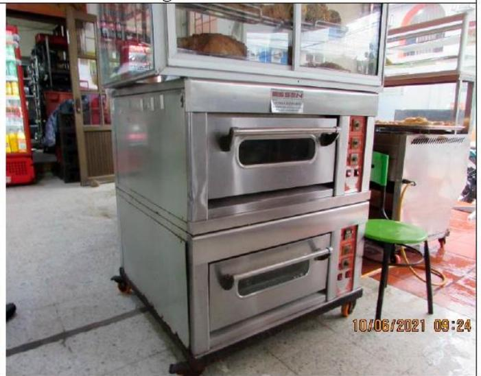
IMG25 Horno a gas marca Essen no funciona
