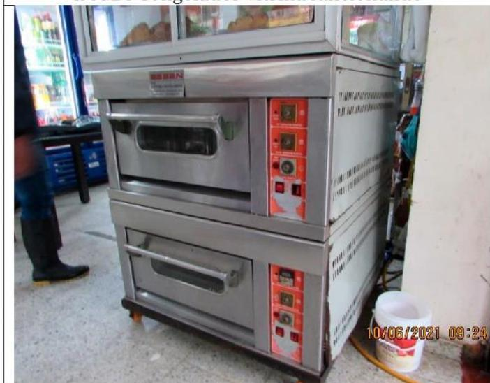
IMG26 Horno a gas marca Essen no funciona
