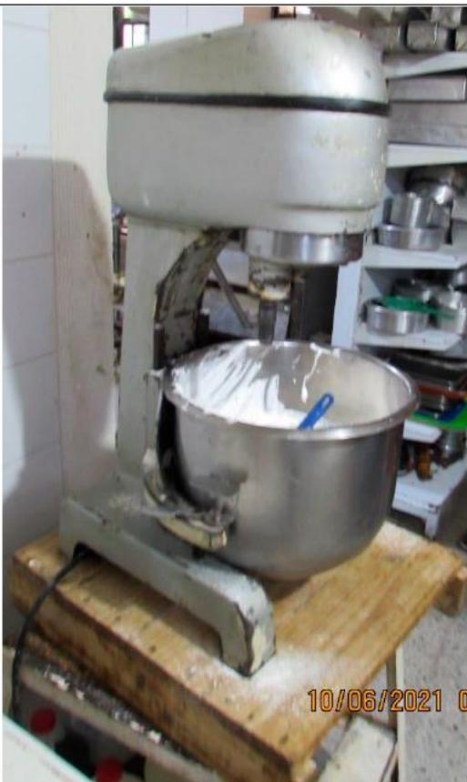
Batidora marca Chain Speed con olla, modelo 120214, se encuentra en funcionamiento, en regular estado de conservación y requiere mantenimiento preventivo.
