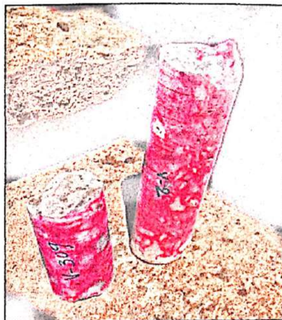
Img. Núcleos extraídos y rociados con fenolftaleína del nivel +0.35 columna C15, vigas del nivel Sótano V-309 y nivel 0.00 V-2
