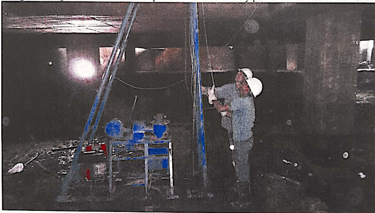
Fotografía 7. Ejecución del sondeo 3 para toma de muestras y pruebas de resistencia in situ.
