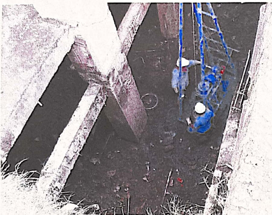
Fotografía 7. Ejecución del sondeo 3 para toma de muestras y pruebas de resistencia in situ.
