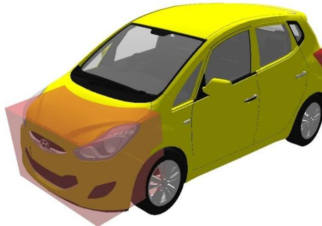
**Imagen No.7:** En esta imagen basada en los reportes se resalta la zona de daños y evidencias en el rodante. Elaboración en el software Trimble Forensic Reveal.
