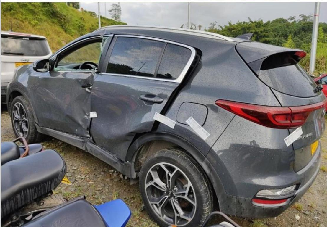
**Fotografías No.10 y 11 Plano Medio:** En estas fotografías se observa las deformaciones estructurales en el tercio medio del lado izquierdo, nótese la afectación en la puerta anterior y posterior de la camioneta.
