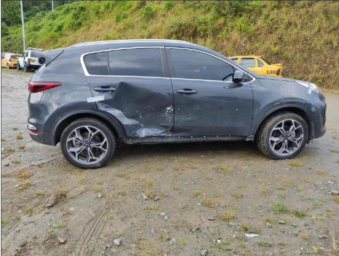
**Fotografía No.9 Plano Medio:** En esta fotografía se observa el estado final de la camioneta la cual presenta afectación en el lateral derecho, compatibles con abolladura en tercio medio más hacia el tercio posterior.
