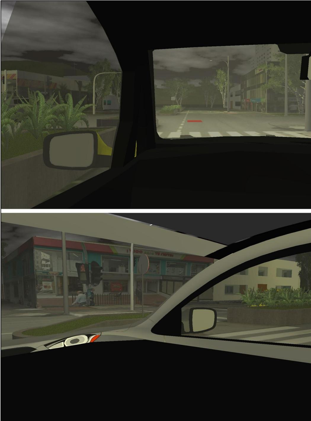
**Imagen No.31:** En esta imagen en 3D se observa la visibilidad que tenía los conductores de los vehículos a 1,5 s antes del impacto si su velocidad es constante.
