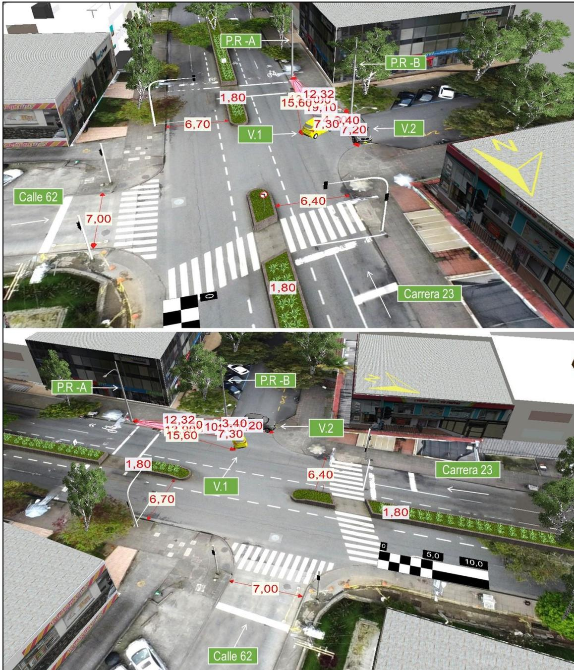
**Imagen No.13:** En estas imágenes, vista en 3D de la elaboración a escala en el software Trimble Forensic Reveal se observan las evidencias diagramadas en el croquis de la autoridad.
