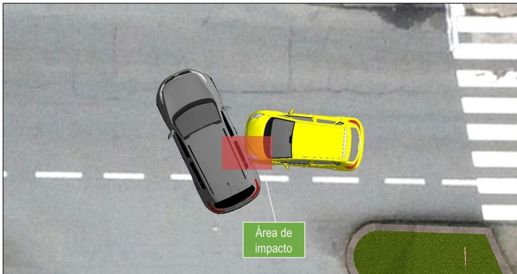
**Imagen No. 20:** En esta imagen vista en planta se muestra la posición relativa de los vehículos al momento del impacto y el área donde se presentó, elaborada en el software Trimble Forensic Reveal.
