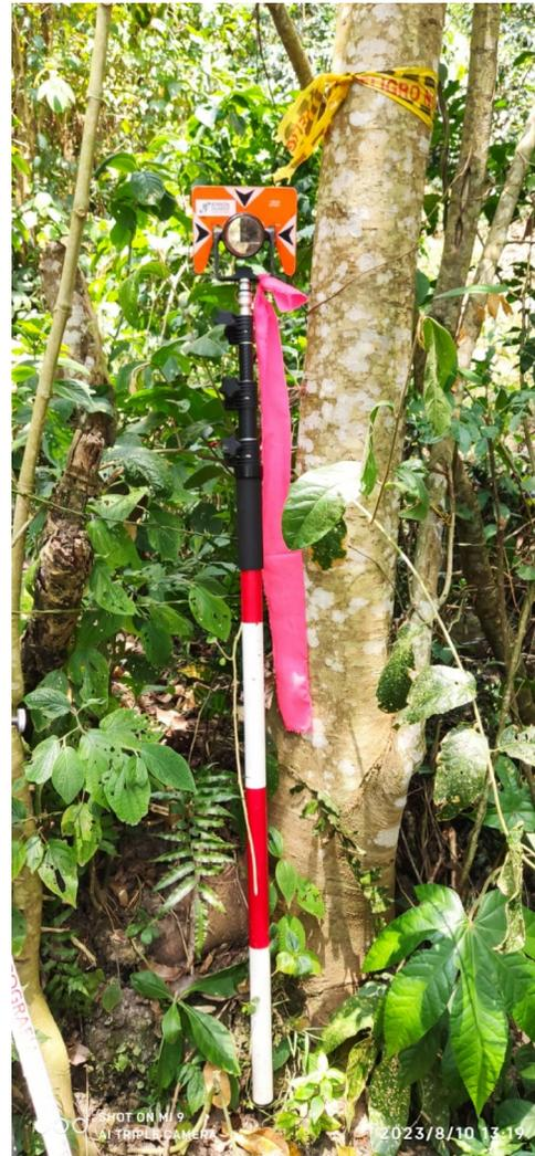
imagen 7,8, empleo de reflectores – prismas para el levantamiento topográfico sobre puntos indicados por los interesados.
