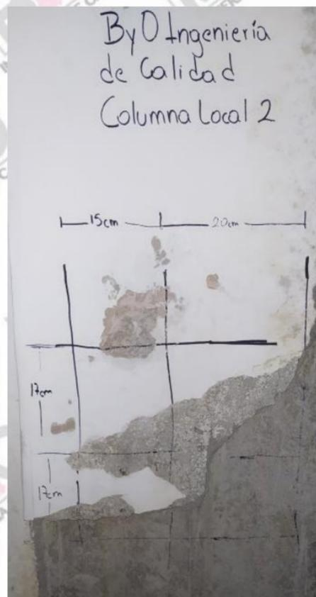
• **Ensayo Regata para Verificación de Acero y Carbonatación**
