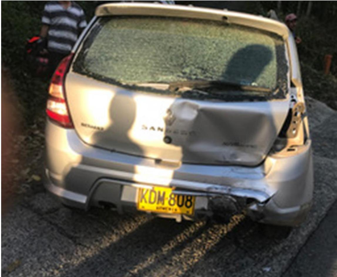
**FOTOGRAFÍA No. 8 PLANO MEDIO:** En esta fotografía se observa el estado final del vehículo, el cual presenta daños en su zona posterior, más hacia el tercio derecho, afectando piezas como: paragolpes, unidad de luz posterior derecha (stop), quinta puerta y panorámico posterior.
