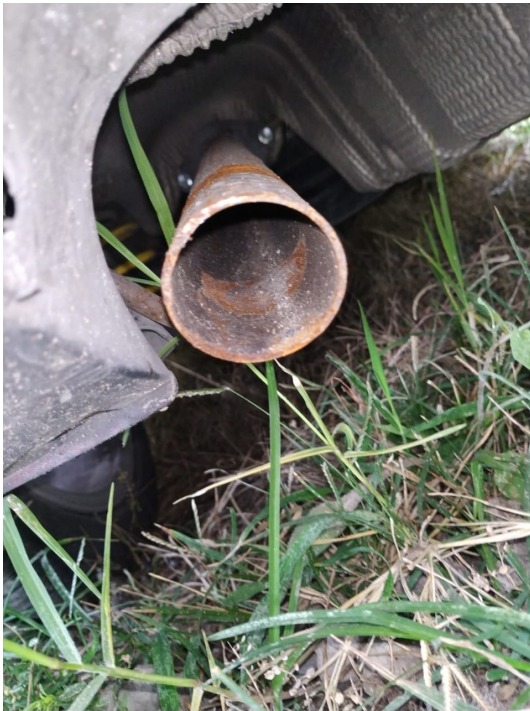
Tubo de escape sin hollín y tornillería nueva
