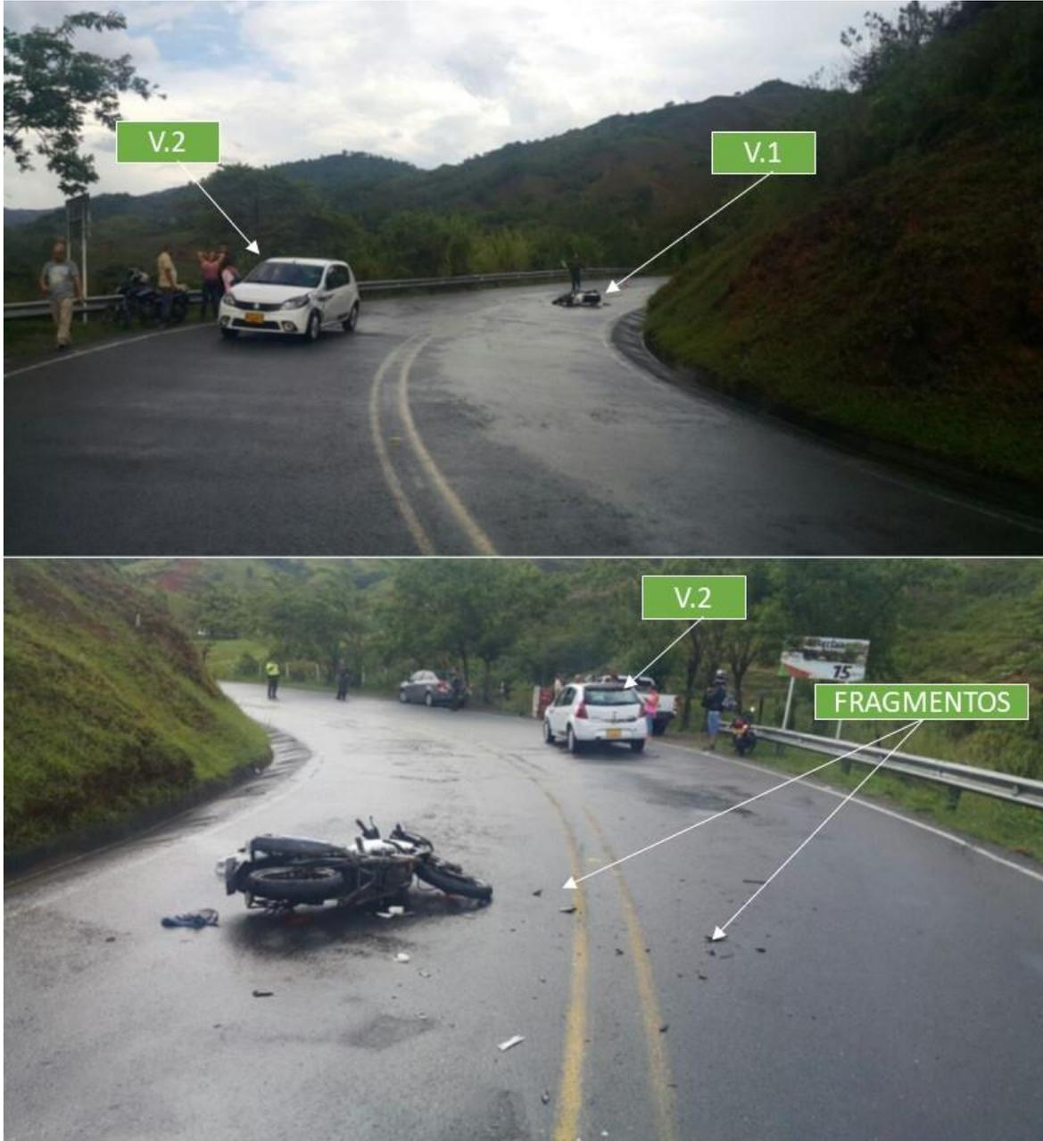
**IMAGEN No.19:** compuesta por registros del álbum fotográfico de policía judicial, donde se observa la relación entre la posición final de los vehículos, estado de la superficie, demarcación y presencia de fragmentos sobre la zona media de la calzada (rastros no acotados en el bosquejo del IPAT).
