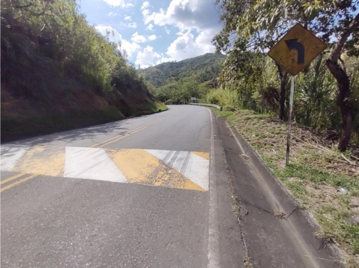
**FOTOGRAFIA No.2:** sentido Cauyá – Y Cerritos curva del Km 44+700, donde se observan las características generales del tramo de vía, morfología, estado, demarcación y señalización actuales. En este sentido se desplazaba el vehículo No.2 Automóvil.
