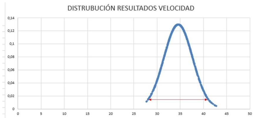
Imagen donde se observan los resultados de velocidad en km/h siguiendo una distribución normal en proceso de análisis de MonteCarlo. (imagen autor)
