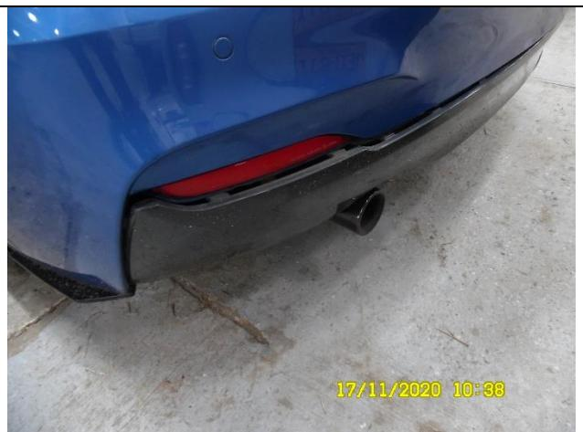
IMAGEN 6 Toma: Acercamiento para ilustrar, en detalle, el desajuste en el lado izquierdo del bomper posterior del rodante de placas N° DSX – 670. -
