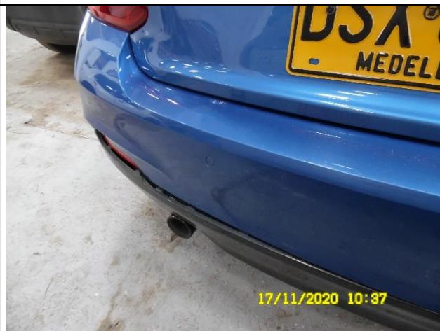
IMAGEN 5 Toma: Acercamiento para ilustrar el desajuste en el lado izquierdo del bomper posterior del rodante de placas N° DSX – 670. -
