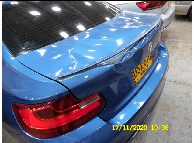
IMAGEN 4 Toma: Acercamiento para ilustrar, desde otro ángulo, la abolladura en la parte posterior de la tapa del baúl del rodante de placas N° DSX – 670. -
