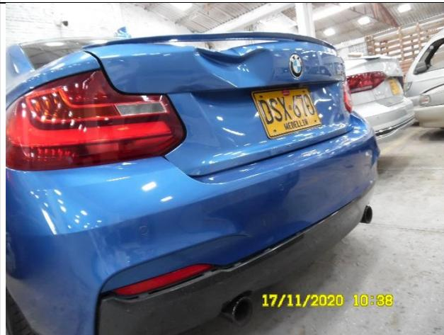
IMAGEN 7 Toma: Acercamiento para ilustrar, desde otro ángulo, la abolladura en la parte posterior de la tapa del baúl y el desajuste del bomper del rodante de placas N° DSX – 670. -
