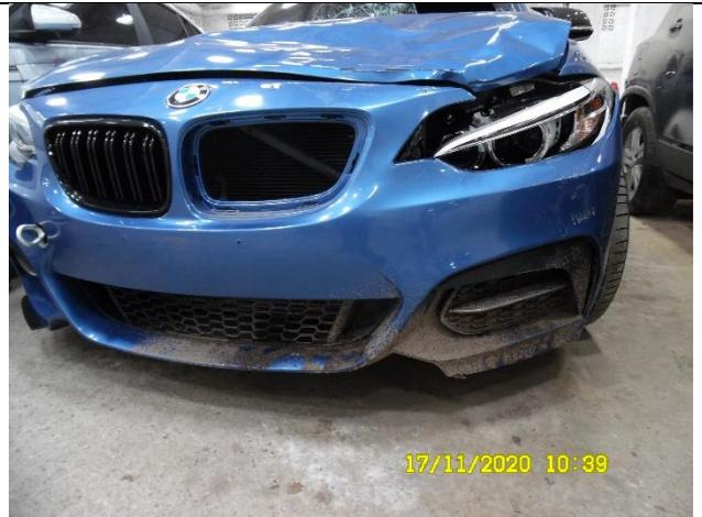
IMAGEN 12 Toma: Acercamiento para ilustrar la ausencia de la persiana izquierda, la ruptura de la farola izquierda y las muestras de tierra en el bumper del rodante de placas N° DSX – 670. -
