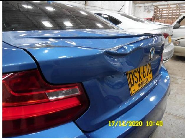
IMAGEN 3 Toma: Acercamiento para ilustrar el desprendimiento lado izquierdo del spoiler del rodante de placas N° DSX – 670. -
