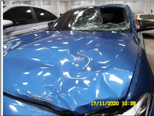
IMAGEN 15 Toma: Acercamiento para ilustrar la abolladura en la parte izquierda del capó del rodante de placas N° DSX – 670. -
