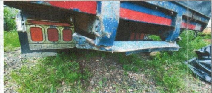
**IMAGEN 11:** se observa tercio posterior del automotor, parte inferior, apreciando deformación del posapie.
