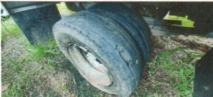
**IMAGEN 6:** se observa conjunto de la rueda posterior del lado derecho, la cual presenta daños en la superficie de rodadura.
