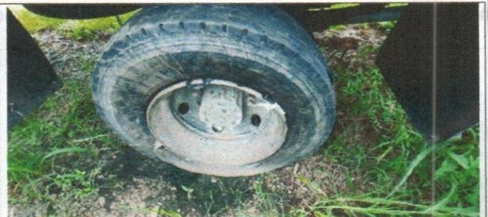
**IMAGEN 8:** se observa conjunto de la rueda posterior del lado derecho, la cual presenta daños en el rin.
