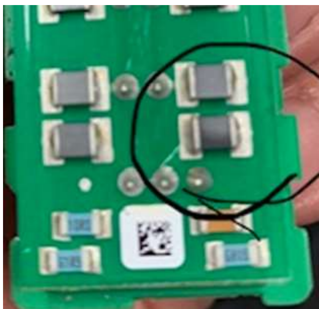
Fotografía 15. La conexión estrella presenta una tonalidad por elevación de temperatura.
