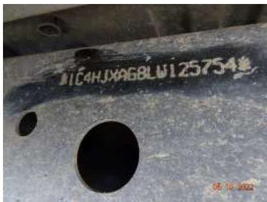
Fotografía 2. Serial VIN de identificación del vehículo ubicado en la viga derecha del chasis.
