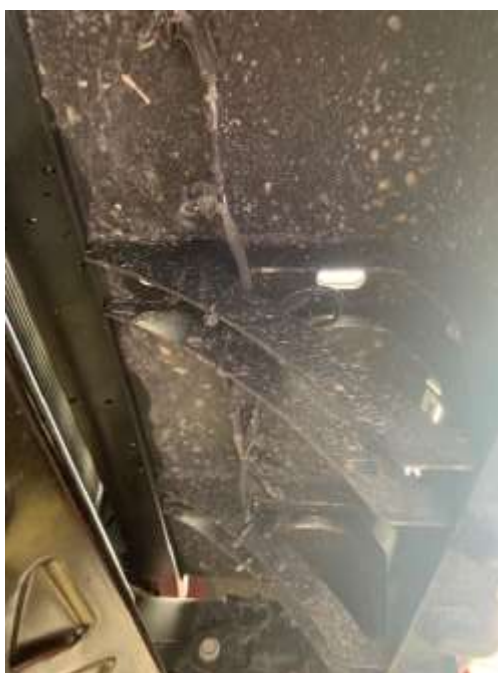
Fotografías 13. Suministrada por Automotriz Italoamerica S.A.S para análisis y evaluación de la instalación eléctrica realizada. Se observa cableado protegido con cinta aislante y sin la funda de protección.
