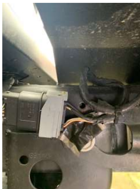
Fotografías 13. Suministrada por Automotriz Italoamerica S.A.S para análisis y evaluación de la instalación eléctrica realizada. Se observa cableado protegido con cinta aislante y sin la funda de protección.
