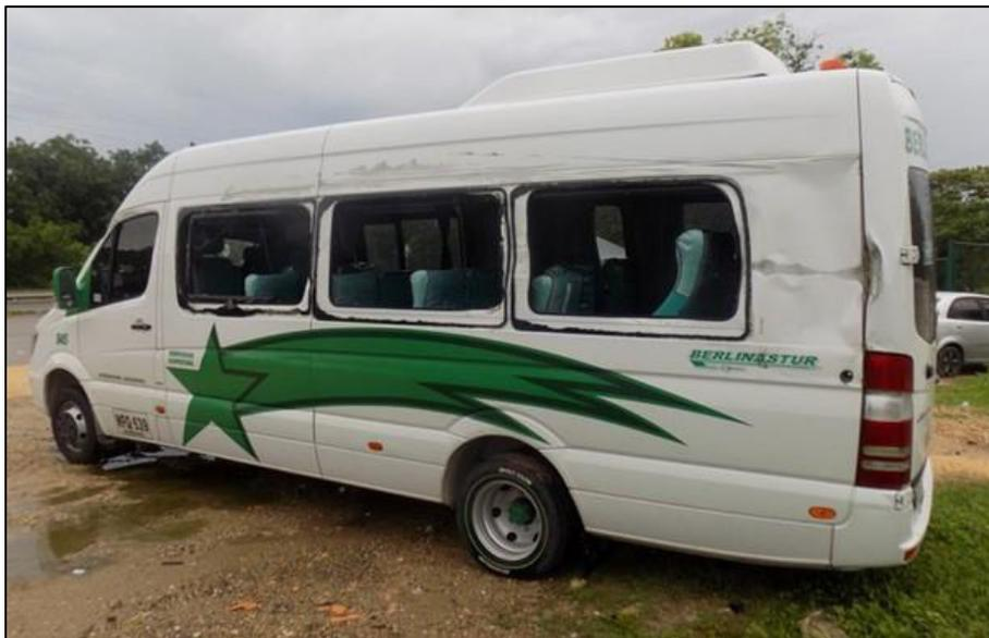
**FOTOGRAFÍAS No. 13 y 14 PLANO MEDIO:** En estas fotografías se aprecia el estado final del vehículo, el cual presenta daños en su zona anterior y posterior costado izquierdo, afectando piezas como: par anterior izquierdo doblado, vidrios del costado izquierdo rotos, abolladuras y rayones en la lámina superior del costado izquierdo y par posterior izquierdo, abolladuras en la puerta posterior, entre otras cosas.
