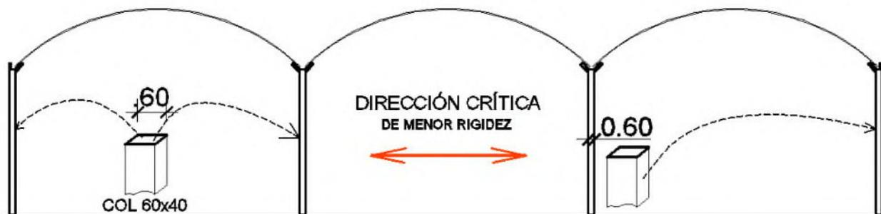
Como se puede observar, el aumento de la inercia en la dirección “X”, de la estructura, es bastante significativo. (2.11 veces), contribuyendo a mejorar la rigidez de la estructura y el comportamiento estructural de la bodega y oficinas.
