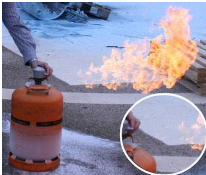
Imagen No. 7 Llama por fuga de gas. Detalle de zona sin combustión.
