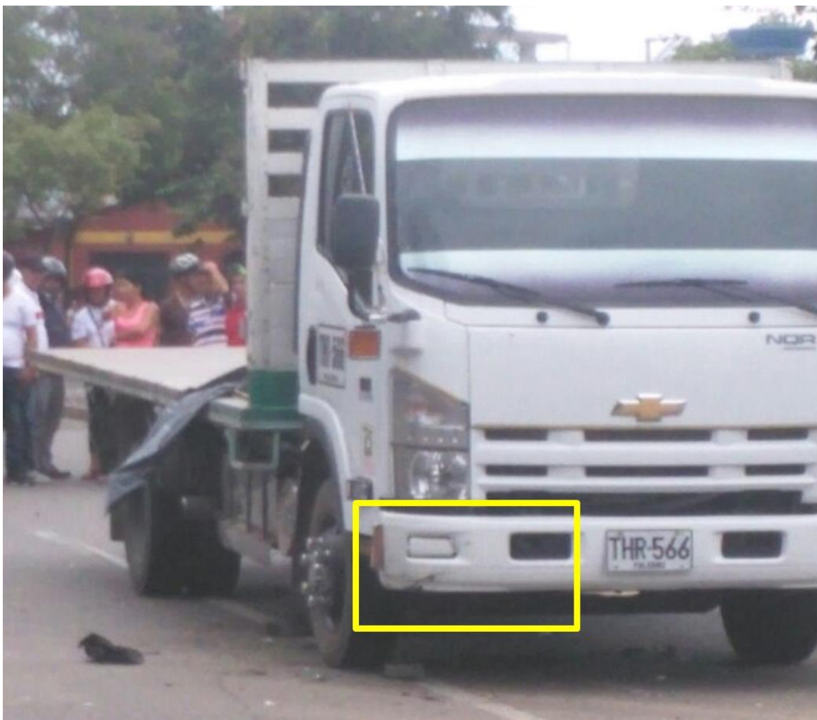
FOTOGRAFÍA No. 5 PRIMER PLANO : En esta fotografía se aprecia el estado final del vehículo, el cual presenta daños en su vértice anterior derecho, afectando el paragolpes.
