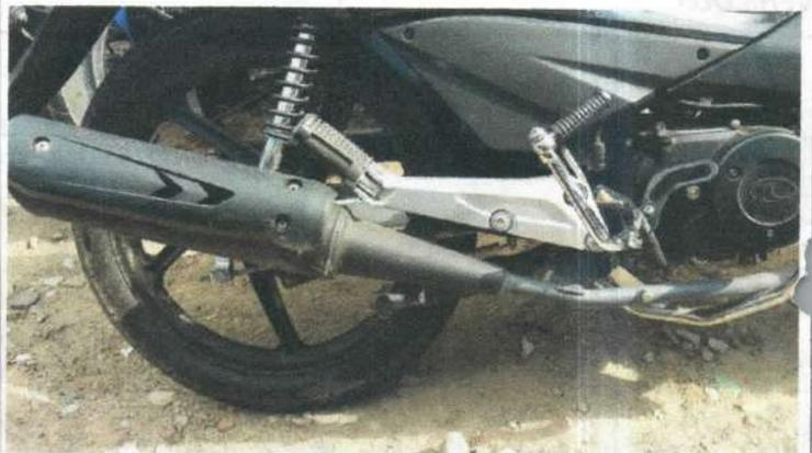
PRESENTA FISURA CON RAYADURA POR FRICCION CON UNA SUPERFICIE ASPERA, DEL CARENAJE LATERAL DERECHO.
