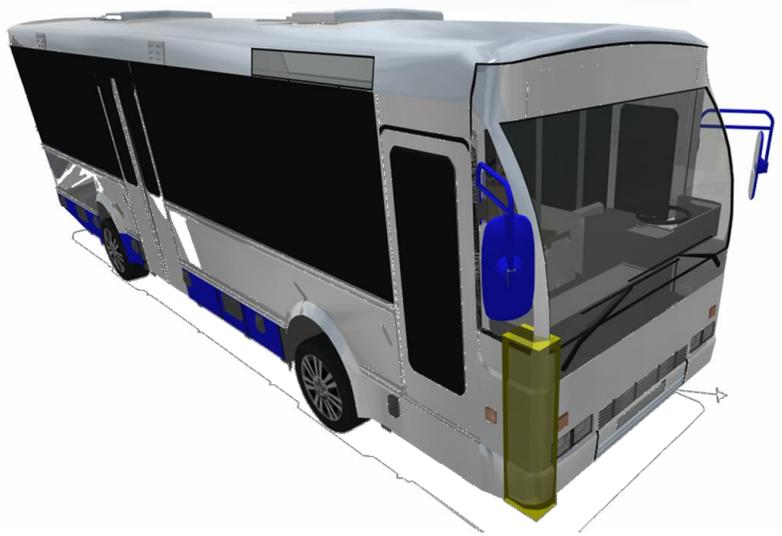
**Imagen No.7:** En esta imagen basada en los reportes se resalta la zona de daños y evidencias en el rodante.
