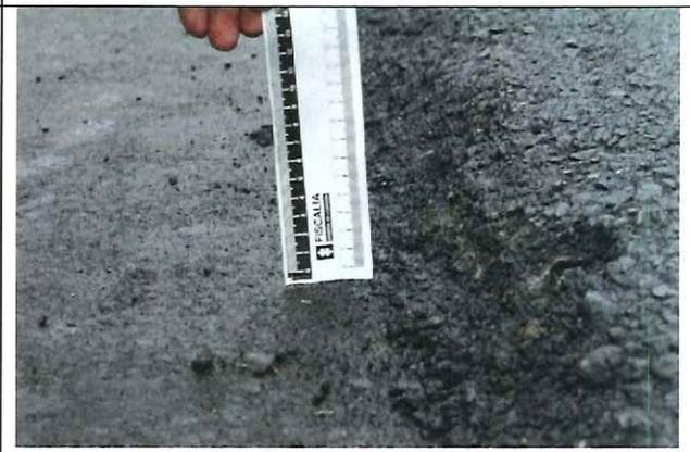
**IMAGEN 44. TOMA 95.** Altura de la capa de pavimento nueva aproximadamente 6 centímetros.
