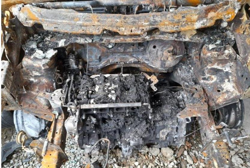
**Figura 2. Motor y sus elementos entre ellos la instalación eléctrica calcinados.**
