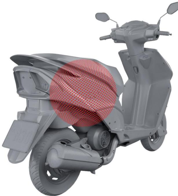
**IMAGEN 13.** Imagen del Software de HUM3D la cual registra la ubicación del daño de acuerdo con las evidencias fotográficas
