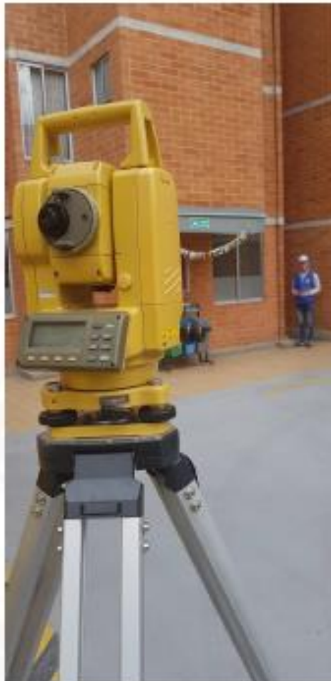
IMAGEN N3: Toma de lecturas coordenadas X - Y FUENTE: Elaboración propia
