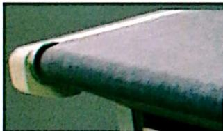
Sistema de banda que permite el corte de materiales flexibles
