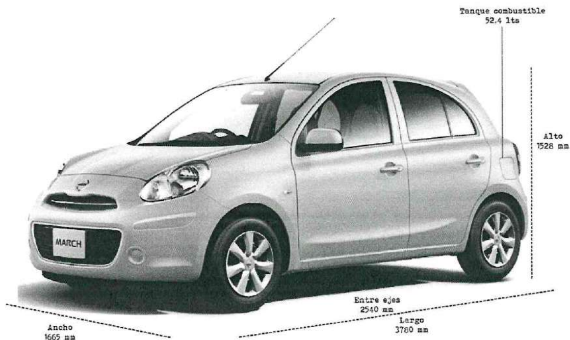
Ilustración 1 Dimensiones Nissan March - Vehículo de tipo automóvil
