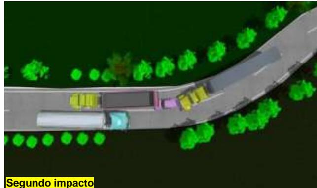
En la fase de conflicto el conductor del tractocamión de placas SYS-663, intenta frenar para no impactar a la camioneta, pero debido a la pendiente de la vía y la superficie húmeda este se desliza produciéndose el primer impacto e impulsando a la camioneta hacia adelante impactándola contra el tráiler del tractocamión que transita delante de la camioneta produciéndose el segundo impacto.
