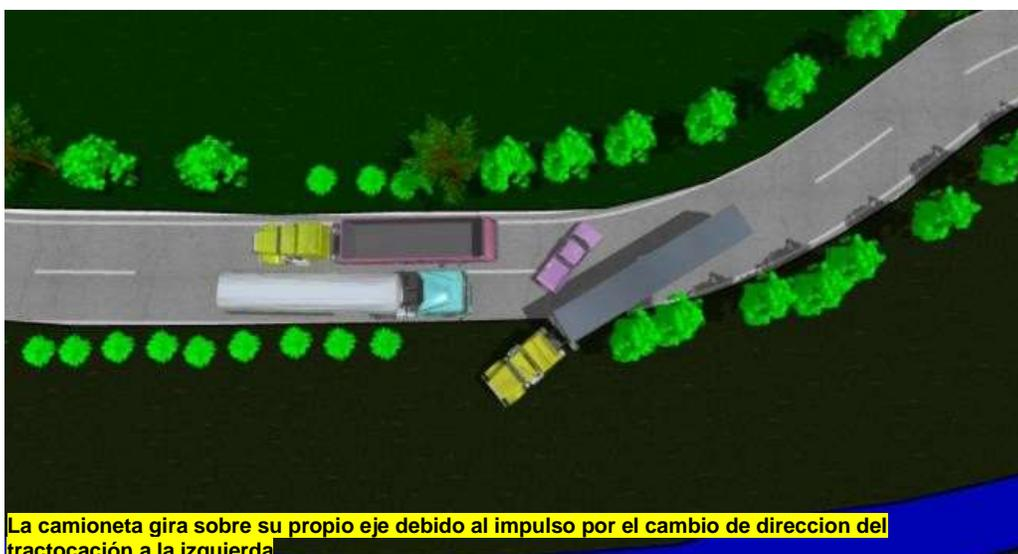
La camioneta gira sobre su propio eje debido al impulso por el cambio de direccion del tractocaci3n a la izquierda
