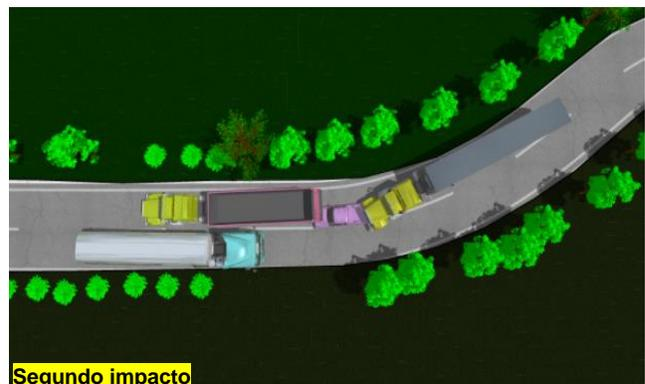
En la fase de conflicto el conductor del tractocamión de placas SYS-663, intenta frenar para no impactar a la camioneta, pero debido a la pendiente de la vía y la superficie húmeda este se desliza produciéndose el primer impacto e impulsando a la camioneta hacia delante impactándola contra el tráiler del tractocamión que transita delante de la camioneta produciéndose el segundo impacto.
