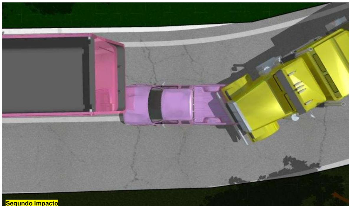
La ubicación de los daños muestra que la camioneta recibió el primer impacto en el vértice posterior derecho y luego este impactó en el vértice izquierdo del tráiler, con el vértice anterior derecho.
