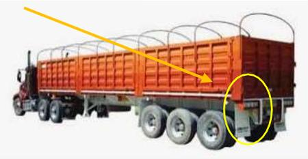
En esta imagen se observa el daño en el vértice posterior del tráiler
