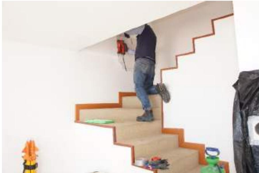
Figura 53 – Proceso lecturas de ferroskan en viga en la Casa No. 5.
