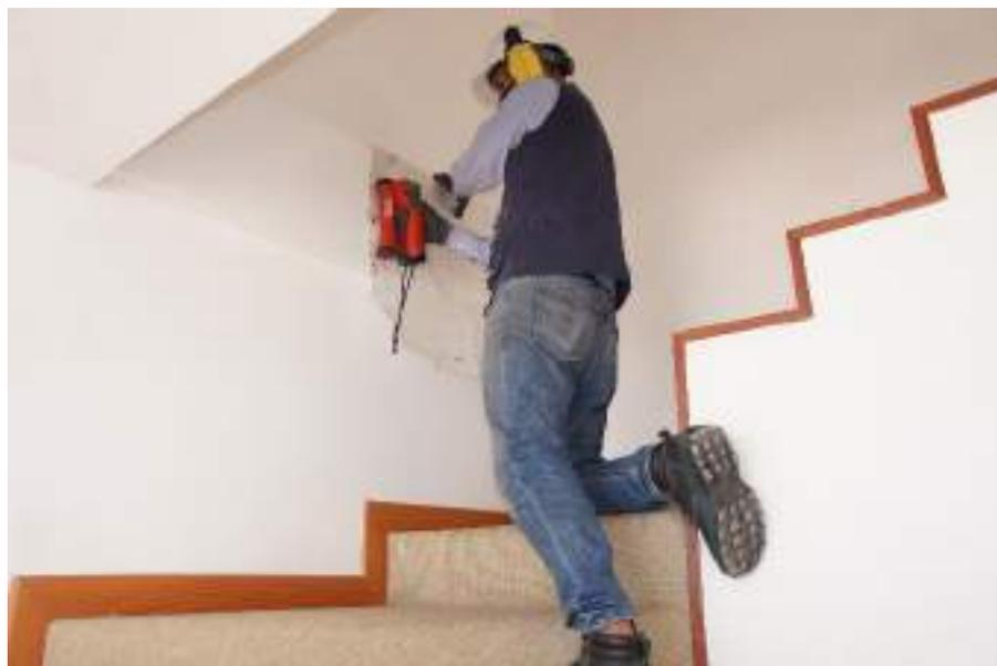
Figura 54 – Proceso lecturas de ferroskan en viga en la Casa No. 5.
