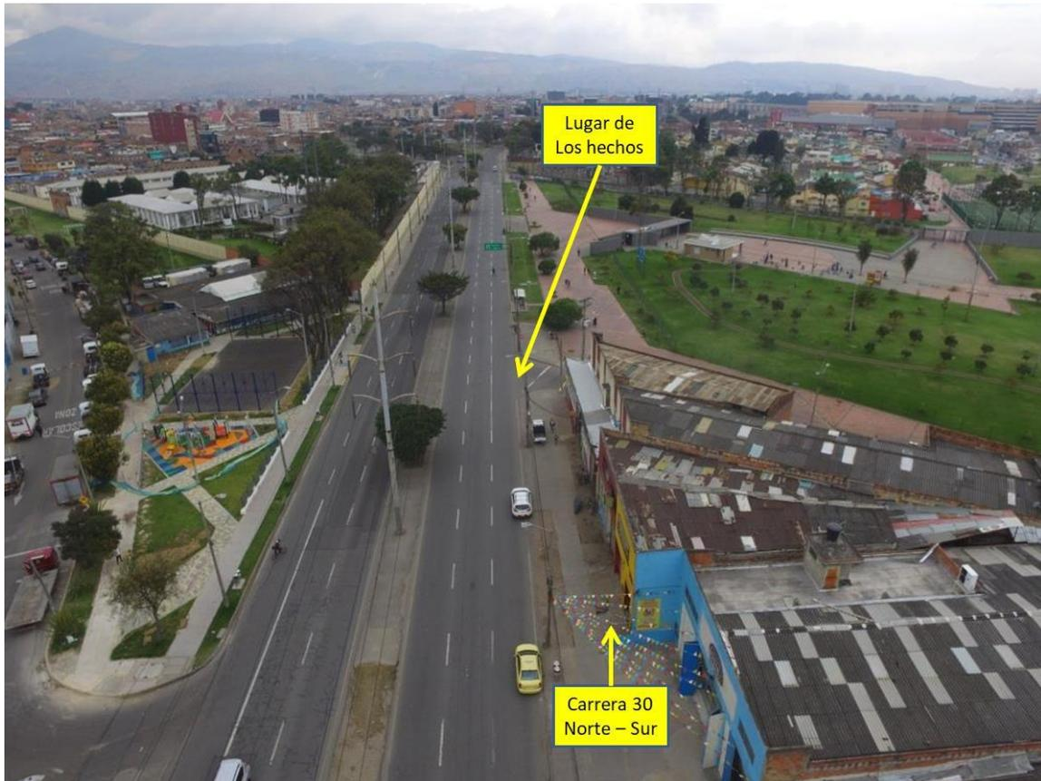
**FOTOGRAFÍA No. 5 PANORÁMICA:** En esta fotografía tomada por el equipo de IRS Vial en sentido norte – sur en la carrera 30 entre calles 31 sur y 32 sur, se aprecian las características generales de la vía en la cual se encuentra demarcación horizontal de línea blanca segmentada y líneas de borde, sin señalización vertical; en este sentido se desplazaban los vehículos.
