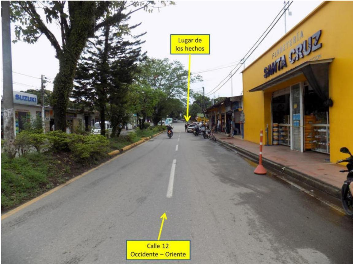
**FOTOGRAFÍA No. 1 PANORÁMICA:** En esta fotografía tomada por el equipo de IRS Vial en sentido occidente – oriente en la calle 12 con carrera 18, se aprecian las características generales de la vía en la cual se encuentra demarcación horizontal de línea blanca segmentada y líneas de borde, sin señalización vertical; en este sentido se desplazaban los vehículos.
