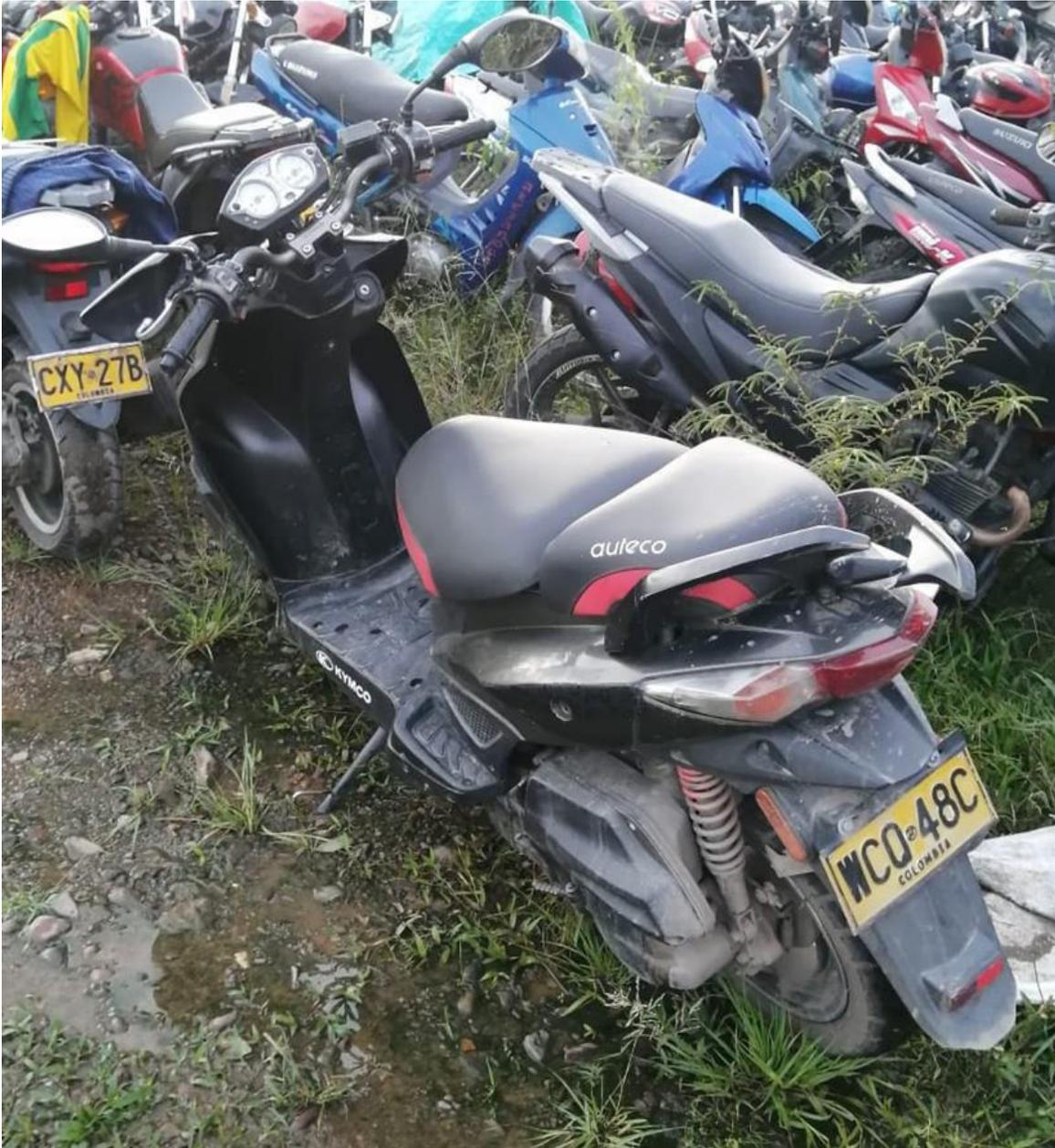
**FOTOGRAFÍA No. 5 PLANO MEDIO:** En esta fotografía se observa el estado final del vehículo, el cual presenta rotura del soporte posterior del costado derecho, sin embargo, no presenta deformación en el guardabarros, la placa o el la luz de parada (stop).
