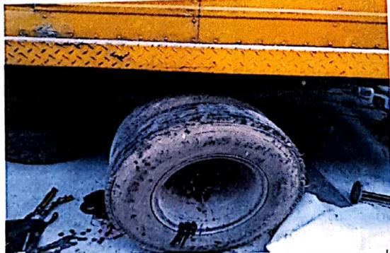
Fotografía tomada proceso desmonte doble rueda trasera, verificación del estado de los componentes del freno tambor trasero lado izquierdo por acceso permisible las piezas que componen este sub conjunto son; tambor, mordaza primaria,
