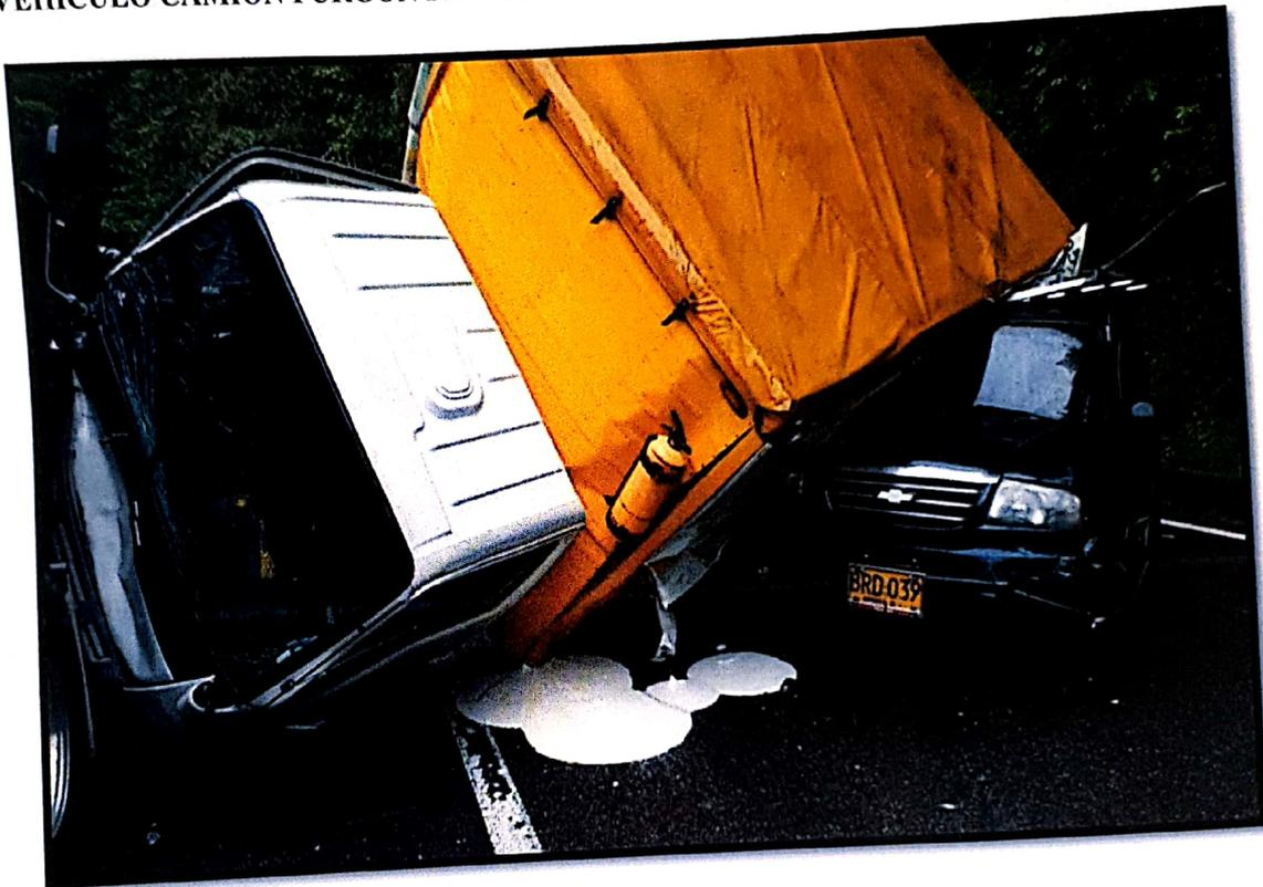
**FOTOGRAFIA N° 1. Plano General.** Se observa poli fragmentación del vidrio panorámico delantero y un volcamiento parcial del vehículo tipo furgón de placas SWK-541.
