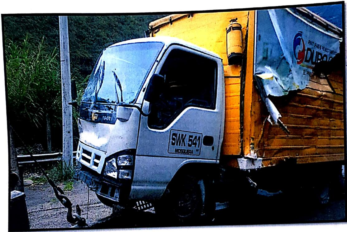
**FOTOGRAFIA N° 2. Plano General.** Se observa fragmentación de panorámico delantero, abolladura en la zona frontal y ausencia total de bomper delantero, abolladura o hundimiento en el costado izquierdo de la carrocería.
