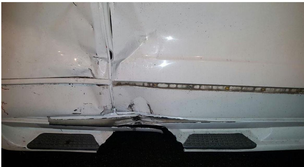
**FOTOGRAFÍAS No. 6 y 7:** En estas fotografías se aprecian los daños en la zona lateral derecha tercio medio y anterior del campero afectando puertas y estribo.
