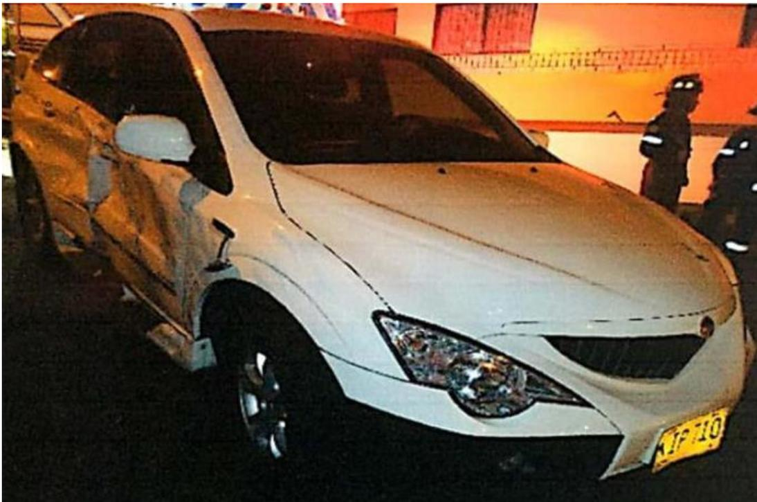
**FOTOGRAFÍAS No. 4 y 5:** En estas fotografías se aprecia el estado final de la zona lateral derecha del campero.
