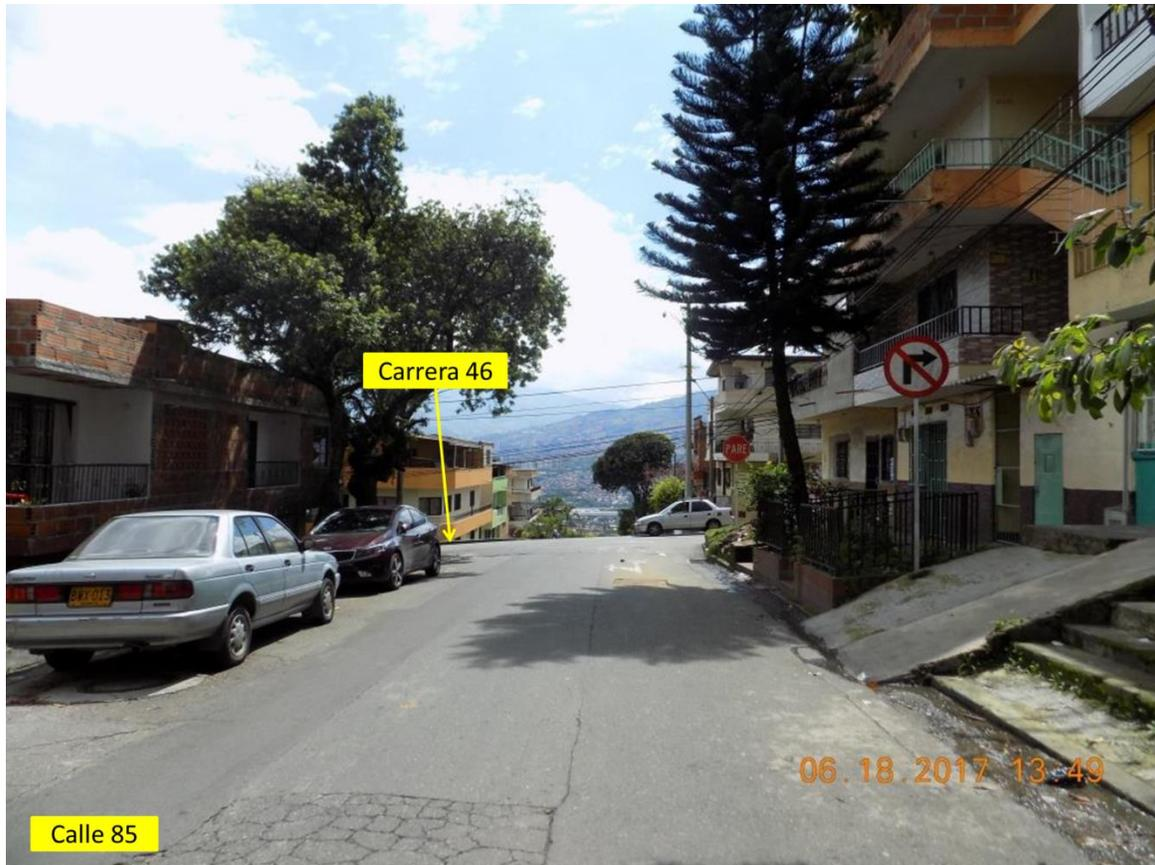
**FOTOGRAFÍA No. 1 PLANO GENERAL:** En esta fotografía tomada desde la calle 85 en sentido oriente – occidente, se aprecian las características generales del tramo de vía donde ocurrió el accidente, el cual presenta señales verticales SR-08 “Prohibido girar a la derecha”, SR-01 “PARE”, y demarcación de PARE (borrosa). En este sentido se desplazaba el vehículo No. 1 Campero.
