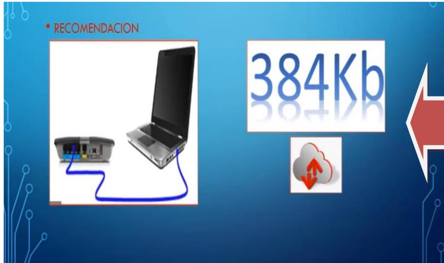
Se recomienda que la conexión se realice a través de un cable de red directamente del computador al modem para evitar la pixelación o degradación de la imagen, corte de la llamada o audio entrecortado.
