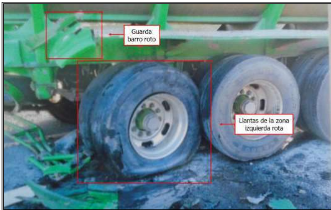
Imagen 3.2 Daños en el vehículo 1 (Tracto Camión)
