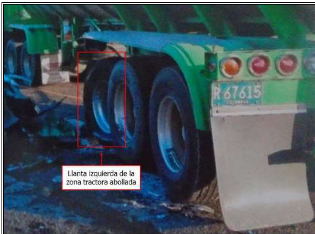
Imagen 3.4 Daños en el vehículo 1 (Tracto Camión)
