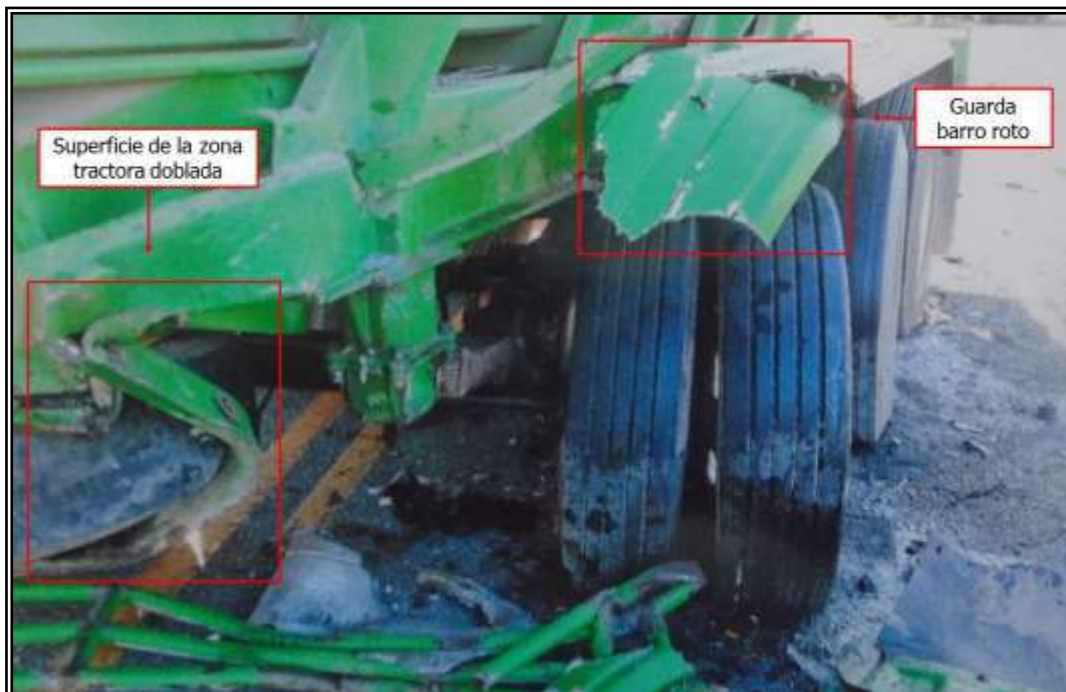
Imagen 3.3 Daños en el vehículo 1 (Tracto Camión)
