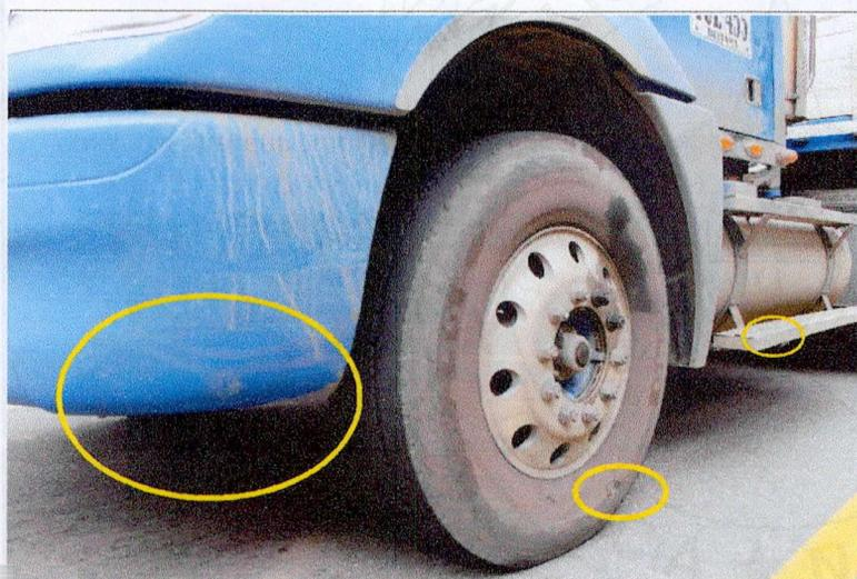
o imagen 7 complementaria a la anterior donde se evidencia huella de limpieza en para golpes delantero lado izquierdo y llanta delantera lado izquierdo a su vez las zonas comprometidas y donde se generaron otras huellas como roce en estribo lado izquierdo y huellas de limpieza en llanta posterior de la unidad tractora y huellas de roce en el primer conjunto de llantas duales del semirremolque
