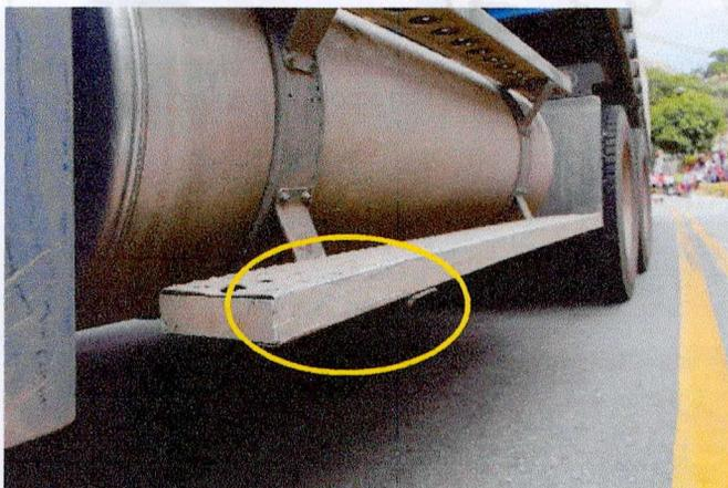
Imagen 8 donde se observa rayón o huella Roce: por la fricción entre dos cuerpos o láminas, dejada en el estribo lado izquierdo cara exterior.
