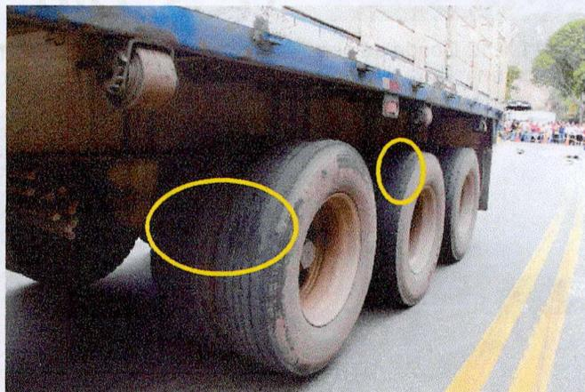
imagen 9 huellas de limpieza en llanta posterior de la unidad tractora y huellas de roce en el primer conjunto de llantas Duales del semirremolque
