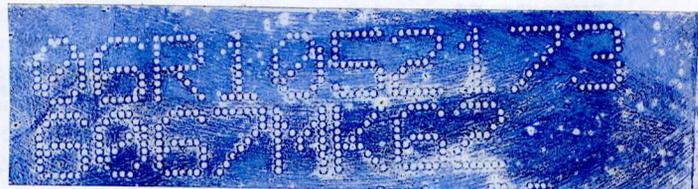
**PLAQUETA DE MOTOR: número de motor ubicado lado izquierdo parte media lado superior cara externa del bloque del motor**
