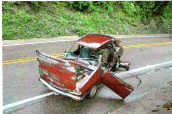
Foto 8. Foto Plano medio: rotura y desplazamiento hacia atrás los parales 1,2 y3 en el lateral izquierdo del vehículo KDC 640, ausencia de su vidrio panorámico y vidrios laterales, desplazamiento de su posición normal puerta delantera izquierda
