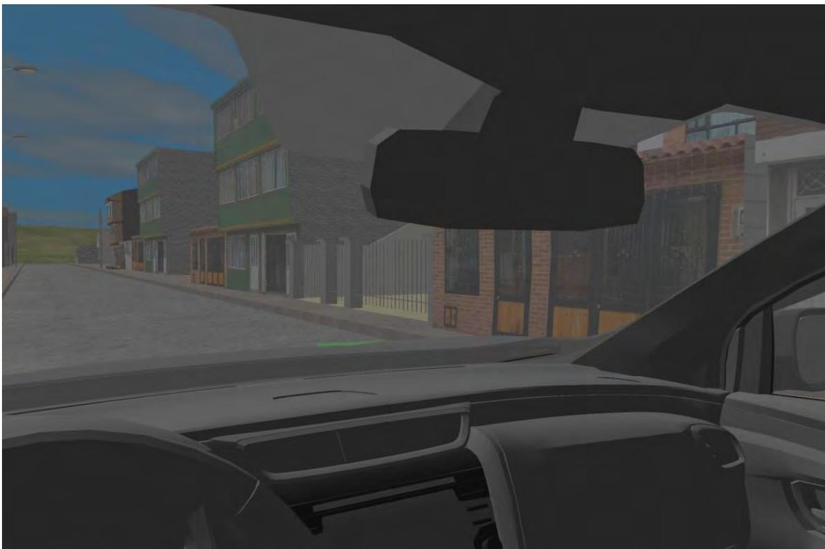
Imagen No. 18: En esta imagen se aprecia la ubicación del área de impacto, de la PEATÓN al momento de la interacción y de la CAMIONETA en el lugar donde posiblemente se encontraba estacionada. Nótese que dentro de la visual del conductor se alcanza a visualizar la parte más alejada del área de interacción con 0,4 metros de extrusión, que está a 5,3 metros del vértice anterior derecho de la CAMIONETA si esta se encuentra detenida en la región amarilla.
