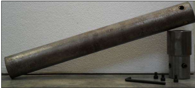
Fotografía 5. Muestreador tipo tubo de pared delgada ("Shelby").
