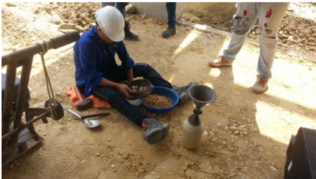
TOMA DE MUESTRAS PARA ENSAYOS DE DENSIDAD AL RECEBO COMPACTADO
