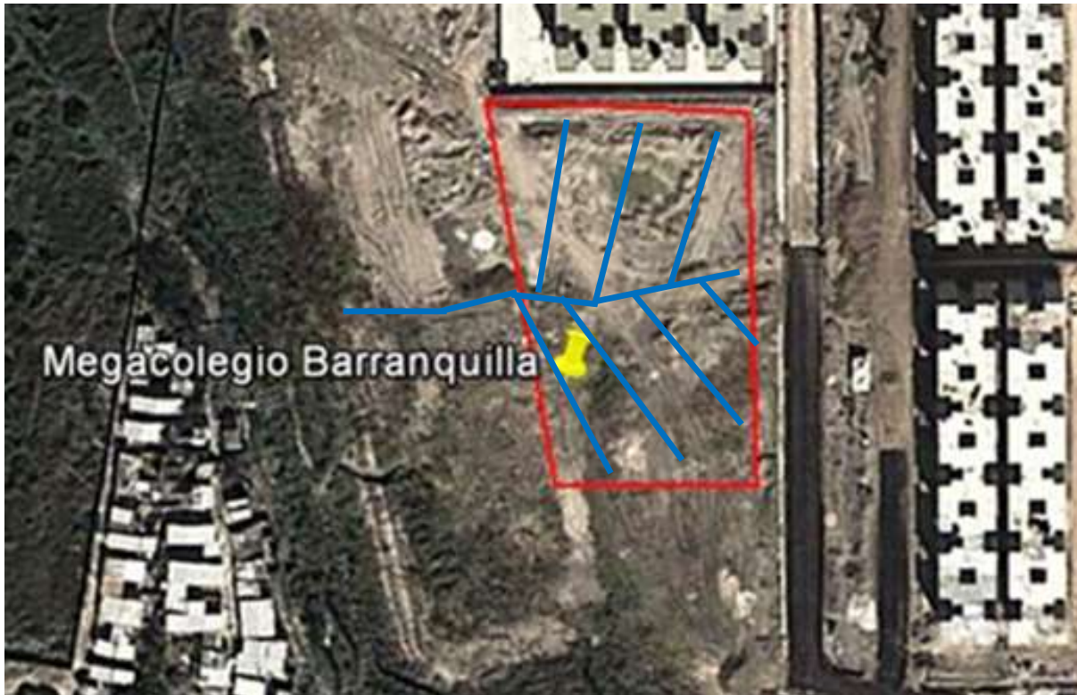
Figura 11. Localización en planta de los filtros de la primera alternativa de mitigación.
