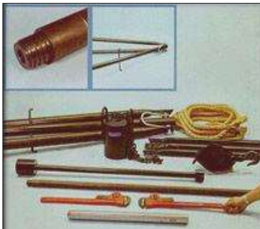
Fotografía 3. Accesorios para la realización del ensayo de penetración estándar (SPT).
