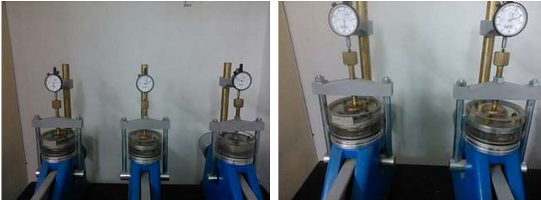
Figura 7. Ensayo de expansión en consolidómetro ejecutado sobre muestras arcillosas.
