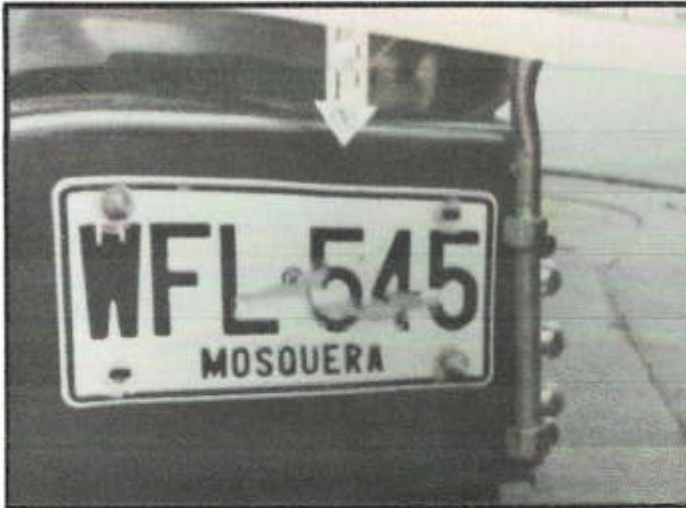
IMAGEN 18. Desprendimiento de pintura de la placa de la volqueta WFL - 545 la cual se encuentra ubicada en el tercio anterior izquierdo del vehículo.
