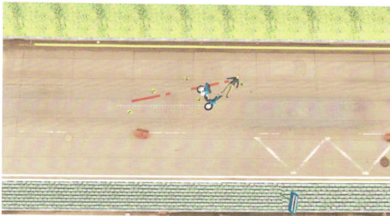
IMAGEN 2. Reconstrucción virtual de la vía y ubicación de las medidas de la fijación de los EMP y EF mediante el uso del software Faro Zone3D.
