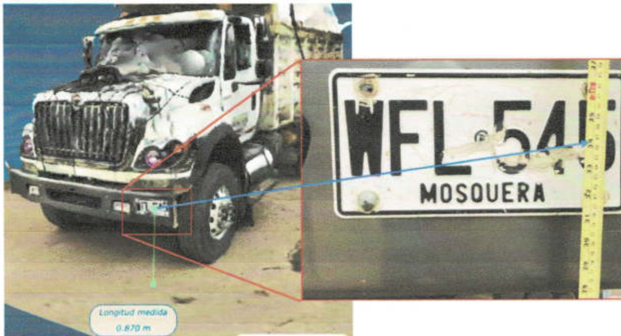
IMAGEN 19. Agregado de material de construcción en la placa WFL - 545 ubicada en el tercio anterior izquierdo de la volqueta a altura entre 84 cms y 87 cms. A la izquierda se ubica la medición a partir de la recreación del vehículo mediante fotogrametría en software e-capture.
