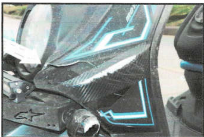
IMAGEN 15. Ruptura y abrasiones en carenaje anterior izquierdo, abrasiones en defensa izquierda de la motocicleta TZN-97E. (pag 61).
