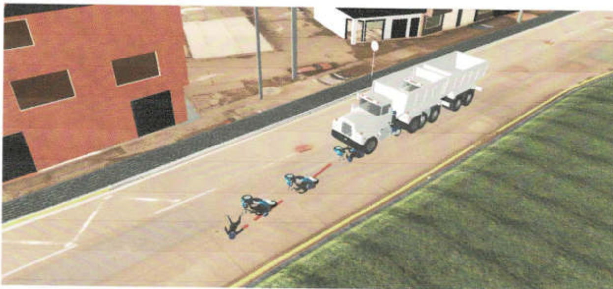
IMAGEN 27. Dinámica del escenario No.2 vehículo volqueta impacta contra la parte posterior de la motocicleta durante una maniobra de desaceleración, generando el arrastre a la motocicleta.
