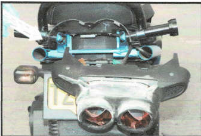
IMAGEN 13. Parte posterior de la motocicleta TZN-97E, ruptura y desalojo de las unidades lumínicas posteriores. (pag 62). Es evidente la demostración de fricción generada en la parte superior de las luces de freno, como se representa en el recuadro (A), roce que no es posible que sea generado por un impacto lineal de atrás hacia delante, por un vehículo de mayor masa y altura.
