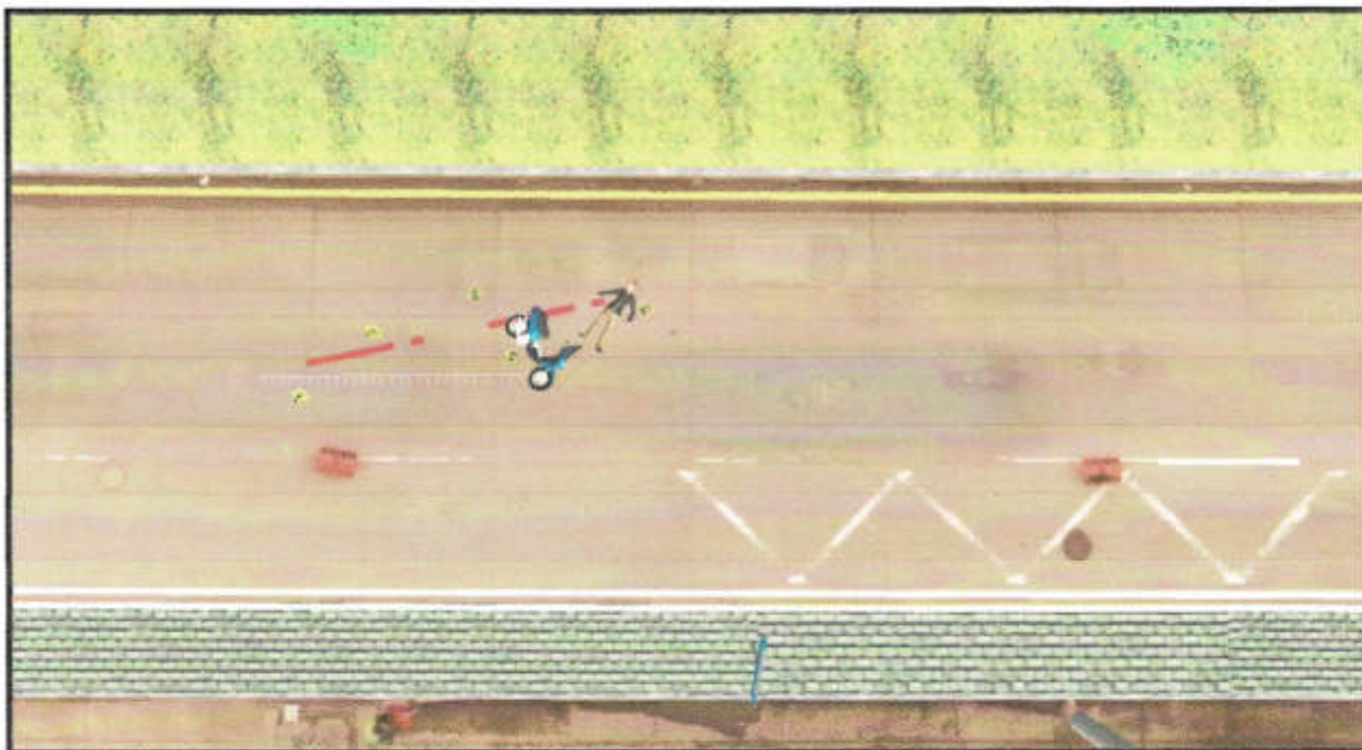
IMAGEN 9. Reconstrucción de posiciones finales a partir del plano topográfico en software Faro Zone3D vista superior.
