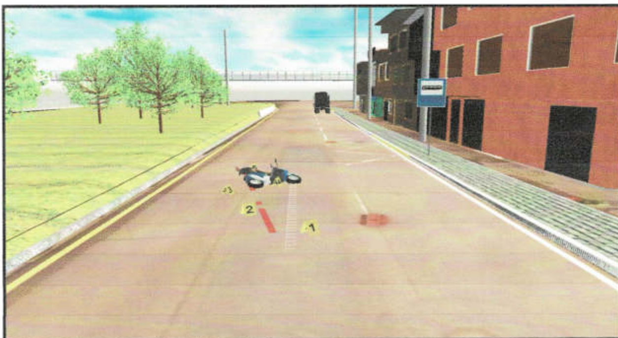
IMAGEN 10. Reconstrucción de posiciones finales a partir del plano topográfico en software Farozone 3D vista en planta en la perspectiva de sur a norte, en el fondo se observa la posición final de la volqueta respecto a la motocicleta y el occiso.
