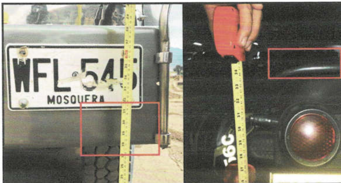
IMAGEN 22. Fotografía de comparación de daños según las alturas registradas.
