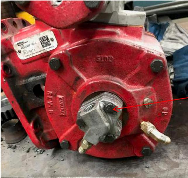
Bomba de lubricacion, venia con diferente sentido de giro al solicitado, por esta causa no lubrico los rodamientos internos.
