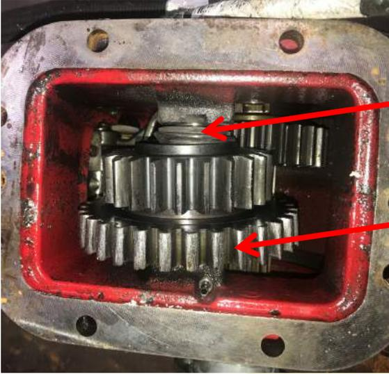
Daño rodamientos por falta de lubricación.
