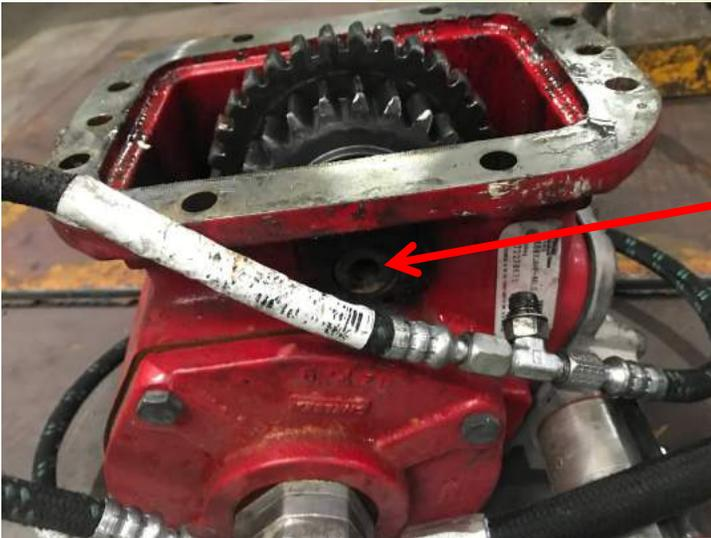
Daño de eje de los rodamientos, la cavidad se vio comprometida.
