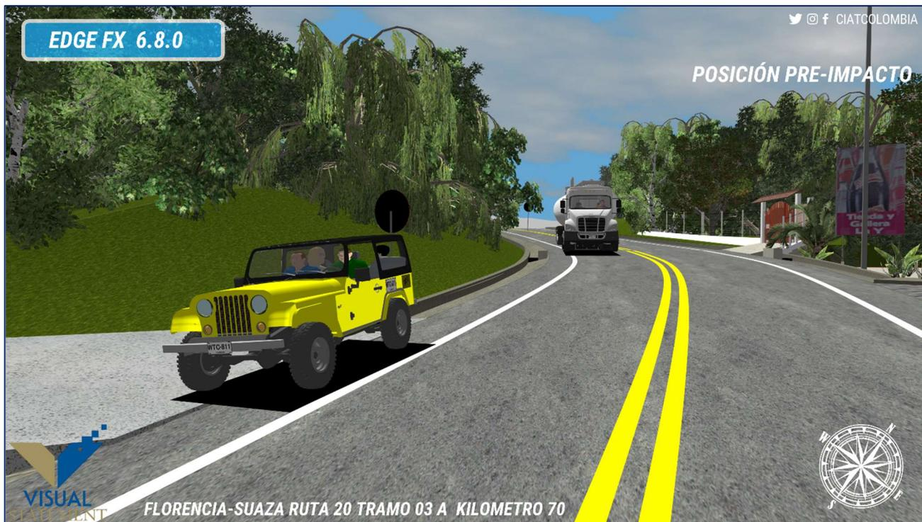
**IMAGEN 4.** Imagen en 3D, tomada del software de reconstrucción Edge FX. A partir de la nube de puntos obtenida durante la investigación de campo, demuestra la posición pre-impacto de los participantes.
